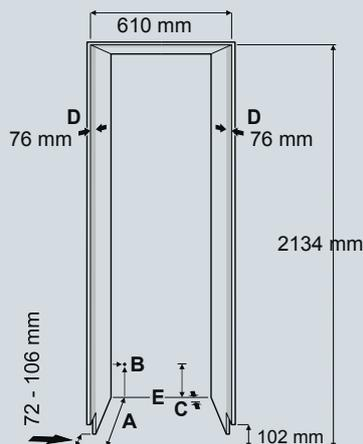
**A** - Profondità dell'apparecchiatura con il pannello esterno: 635 mm con il pannello interno: 635 mm + spessore del pannello personalizzato.
