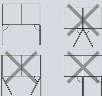
Le apparecchiature Monolith si possono installare affiancate (Side-by-Side) in un elemento modulare. In questo caso è necessario un kit di installazione Side-by-Side (disponibile separatamente) se la distanza tra le apparecchiature installate è inferiore a 102 mm. Per calcolare le dimensioni dell'elemento modulare di installazione, considerare lo spessore della porta e della maniglia.
