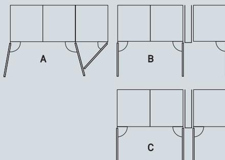
Quando si combinano più di due apparecchiature Monolith insieme, si può scegliere tra differenti opzioni di installazione:
