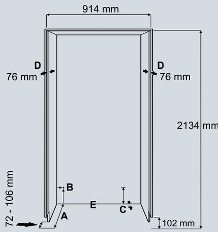
**A** - Profondità dell'apparecchiatura con il pannello esterno: 635 mm con il pannello interno: 635 mm + spessore del pannello personalizzato.
