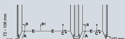
**A** Profondità dell'elemento per il montaggio a filo superficie: 635 mm; per il montaggio integrato: 635 mm + spessore del pannello personalizzato.
