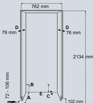
**A** - Profondità dell'apparecchiatura con il pannello esterno: 635 mm con il pannello interno: 635 mm + spessore del pannello personalizzato.
