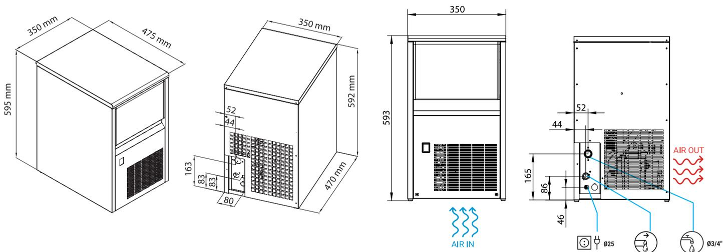
Lo scarico a parete deve essere almeno 10 cm sotto lo scarico della macchina e il tubo di scarico deve essere piegato per fare un sifone
