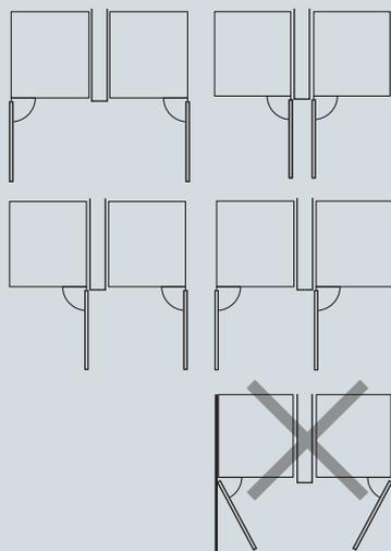
Le apparecchiature Monolith si possono installare affiancate (Side-by-Side) in mobili separati. Se la parete tra i due mobili ha uno spessore inferiore a 102 mm, è necessario un kit di installazione Side-by-Side (disponibile separatamente).
