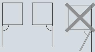
Tutte le apparecchiature Monolith possono essere installate come unità singole, con incernieratura a sinistra o a destra. Per calcolare le dimensioni dell'elemento modulare di installazione, considerare lo spessore della porta e della maniglia.
