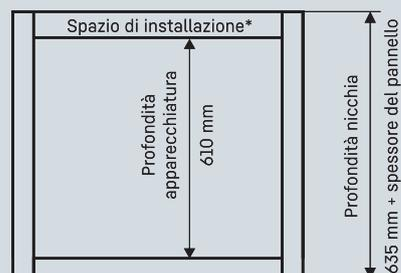
\* Lo spazio di installazione rappresenta lo spazio tra il pannello posteriore dell'apparecchiatura e la parete posteriore della cucina. Questo spazio intermedio consente una comoda installazione dell'allacciamento elettrico e alla rete idrica, nonché del dispositivo antiribaltamento. Se necessario, lo spazio di installazione può essere ridotto (ad es. profondità nicchia 610 mm).
