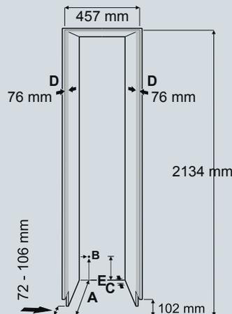
**A** - Profondità dell'apparecchiatura con il pannello esterno: 635 mm con il pannello interno: 635 mm + spessore del pannello personalizzato.
